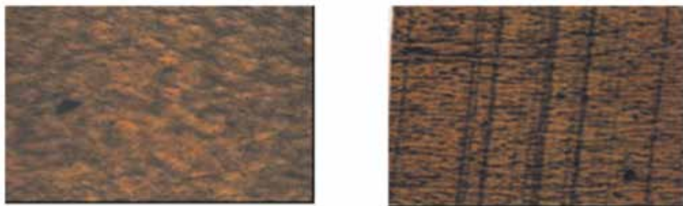
Figura 8. Morfología, visión global, de la mezcla 72A12G16A a 50 aumentos (foto 1) y a 100 aumentos (foto 2)
