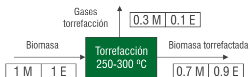
Gráfico 1 Balance de masa y energía en torrefacción
